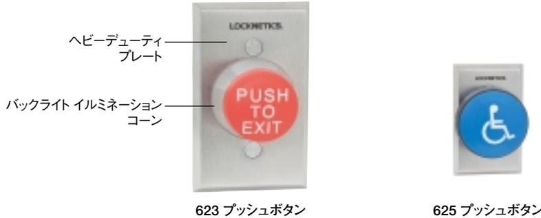
ロックネティクスの620・631シリーズのプッシュボタンは、取付技術者に大変魅力的でやさしく、革新的なものを提供します。モメンタリーアクション(瞬時動作)のモデルでビスターミナルコネクションは、モニターを取るためにグリーンまたは赤のLEDが付くコーン型のバックライトイルミネーションを提供し、オプションのPCボードとL2/ILLを容易に取り付けられるようになっています。追加的オプションはディレイドアクション、2回路同時接続(ダブルボール、ダブルスロー)ヘビーデューティプレートと7つの仕上げ色を含んでいます。交互切り替え型と細型のもを用意しています。
