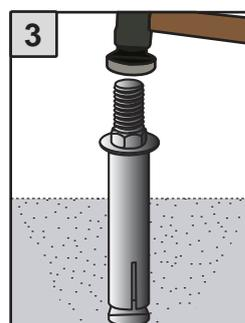
ハンマーでアンカーボルトをワッシャーの部分まで打ち込みます。
