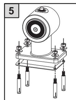
上からマグネット・ドアホルダーを取り付けワッシャー付き六角ナットで締め込みます。
