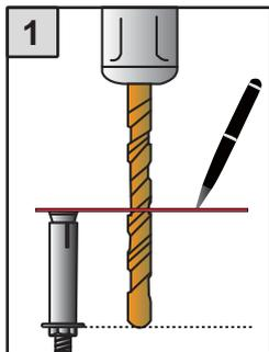
8mmのドリルビットを6mmのアンカーに合わせ、アンカーの長さのところに印をつけます。
