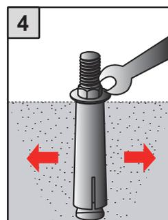
1. アンカーボルトが膨らむまで六角ナットを時計回りに締め込みます。
