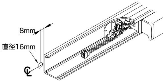
2. ケーブルを穴に通し、ワイヤを通電金具に接続します (必要に応じて「通電金具」の取り扱い手順を参照してください)。
