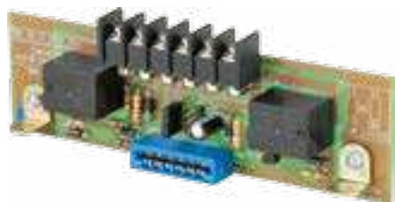
100-2 Two (2) ゾーンコントローラー基盤
