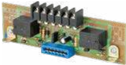
100-2 ゾーンコントローラー基盤
